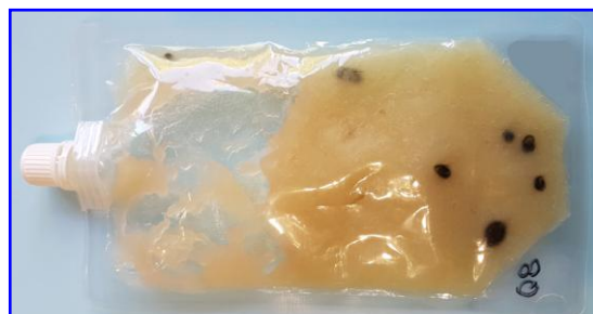
8 ufc Quanti-P/A-CP incubando sólo 24h con 2 errores: sin haber extraído previamente el aire ni haber planchado
